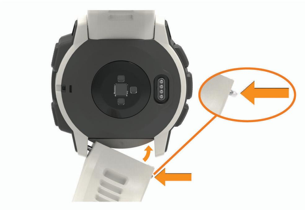
**NOTA:** asegúrate de que la correa está fija. El perno debe quedar alineado con los orificios del dispositivo.
